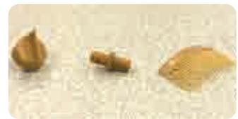
totale-ment recyclé. Cela le distingue du bois MDF appelé couramment le medium <sup>(2)</sup>, fabriqué avec des polymères thermosensibles, donc à usage unique. Autre vertu du WPC, sa fabrication peut être faite par extrusion ou formage dans un moule et génère donc moins de pertes.
