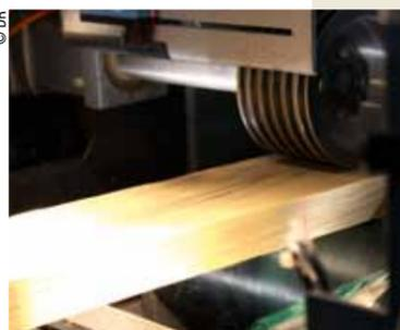
Dans l'usine de Cerisé, un système de vision par caméras couleures enregistre les quatre faces de la pièce et les affiche sur plusieurs écrans. L'opérateur trace virtuellement les différentes qualités avec une tablette graphique, guidant le travail des machines.
